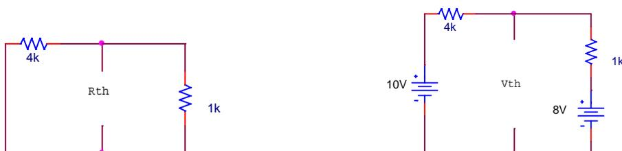
Costruito il circuito equivalente secondo Thevenin si determina la corrente sul ramo,  $I=2,2mA$ . La tensione sul condensatore a fine transitorio sarà quindi:  $V_C = R \cdot I = 1k \cdot 2,2m = 2,2V = V_C(\infty)$ .
